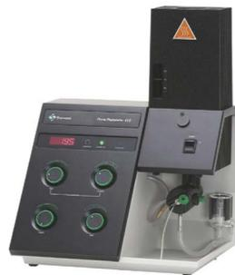
Imagen 27: Fotómetro de llama que hemos utilizado para determinar la concentración de sodio en el agua.
