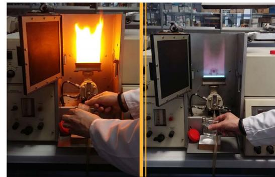
Imagen 29: Espectrofotómetro de absorción atómica.
